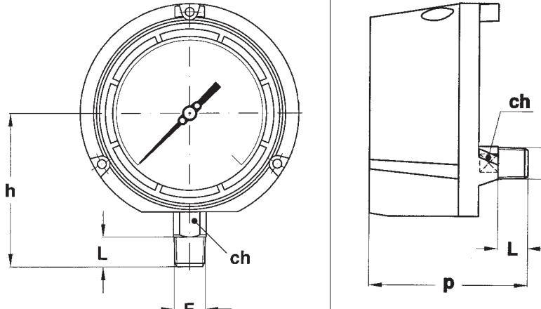
**Барабанный корпус с "прочной передней стороной"**
